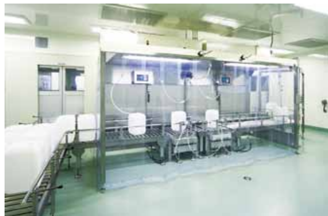
▲高純度製品の充填用クリーンルーム
