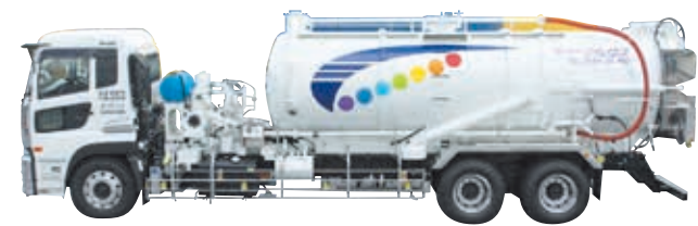
▲14,500リットルの強力吸引車。水、油、泥、土、石など液体なら10トンほどを運搬することができます。
