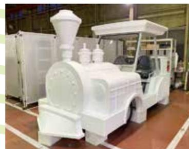
出来上がってきた外装の試作品を取り付けてみたところ。こちらをもとに、外装を取り付ける骨組みを制作します。
