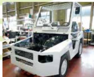
運び込まれたベース車を分解して、骨組みにしていきます。ベースになるのは「トイングトラクター」。空港などで荷物を運搬する車両です。
