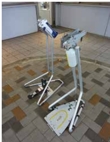
◀手指消毒用「足踏み式除菌スプレースタンド」。足踏みペダルやスプレーボットの取り外しなど、改良を重ねている
