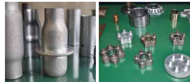
偶然に中央部にツバのついた部品 ファインシェーピング加工の部品
